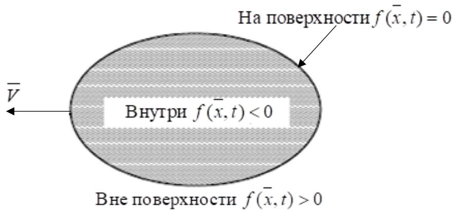
Рисунок 1 – Процедура определения контрольной поверхности в интегральном методе Фокса-Вильямса-Хокинга (*FWH*)
