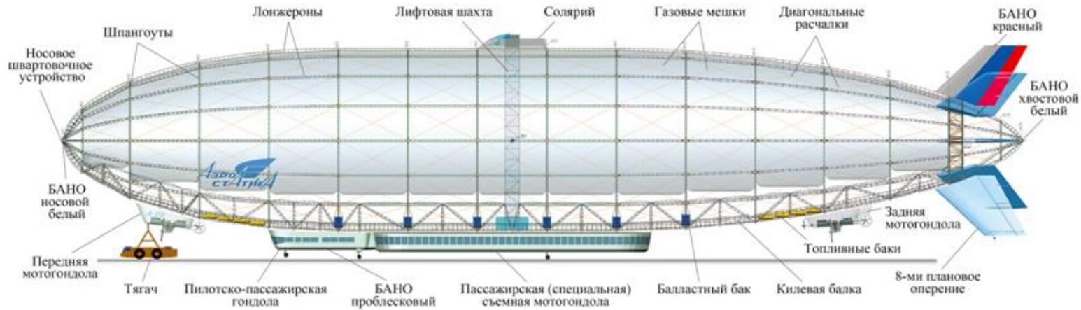
Рисунок 1.3 – Конструктивно – силовая схема дирижабля жесткого типа нового поколения
