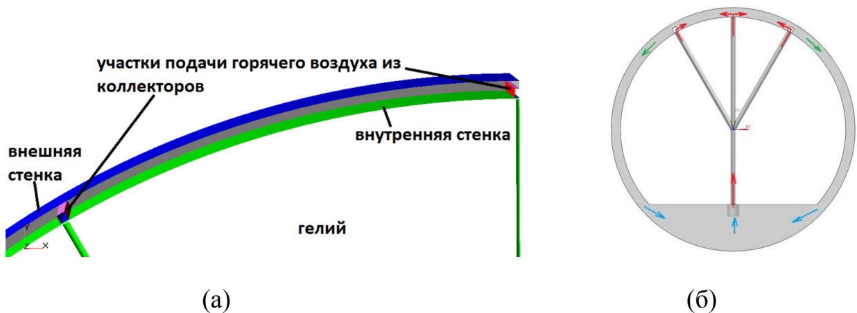
Рисунок 3.23 – Схема подачи теплого воздуха в верхнюю часть оболочки дирижабля
