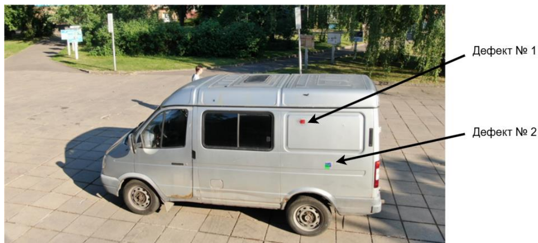
Рисунок 5.11 – Результаты обнаружения дефектов наружной поверхности объекта на основе анализа снимков, полученных аппаратурой мониторинга на борту БЛА
