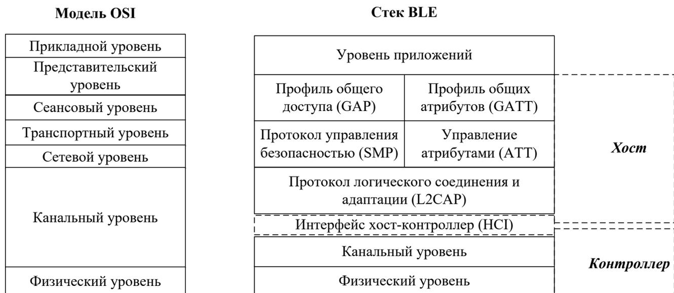
Рисунок 4 – Соотношение стека протоколов модели OSI и BLE.
