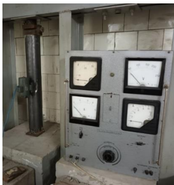
Рисунок 2.10 - Экспериментальная установка для исследования вынужденных колебаний сжатых трубобетонных образцов при различной частоте возмущающего воздействия (регулируемой изменением мощности двигателя): а) общий вид установки; б) плоская схема и расчетная модель: 1 – загружающий рычаг; 2 – испытуемый образец; 3 – цилиндрический опорный шарнир; 4 – электродвигатель с эксцентричным диском; 5 – корзина; 6 – гири; 7 – усиленный ж/б пояс; 8 – блок акселерометра; 9 – модуль обработки сигнала акселерометра; 10 – ноутбук для регистрации осциллограмм и результатов измерений вибрации; 11 – распределительный щит с вольтметром.
