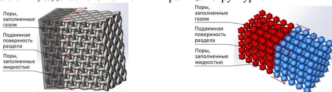
Рисунок 1 – Модели пористых композитных структур, в которых моделируется пространственное течение жидкого связующего и вытесняемого им газа
