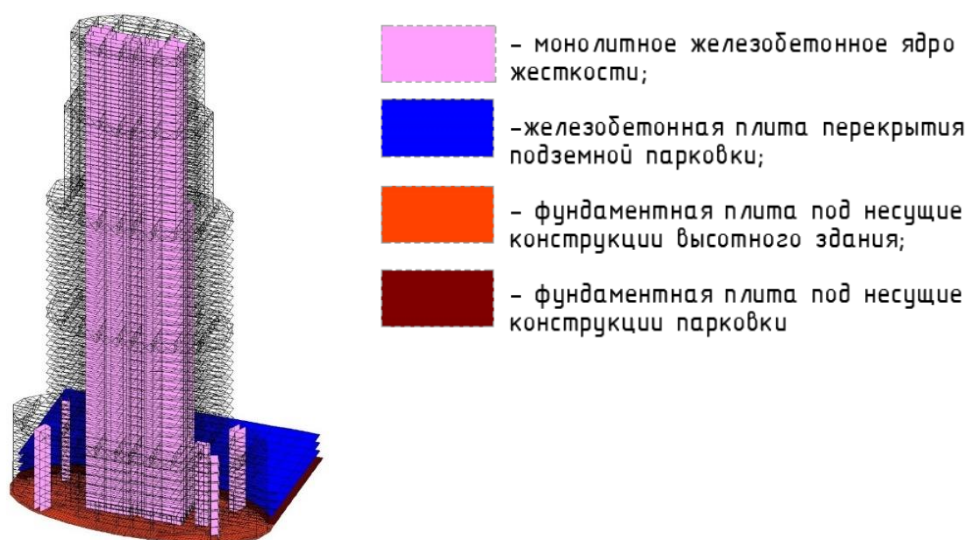
Рис. 4.22. Расчетная модель проектируемого здания
