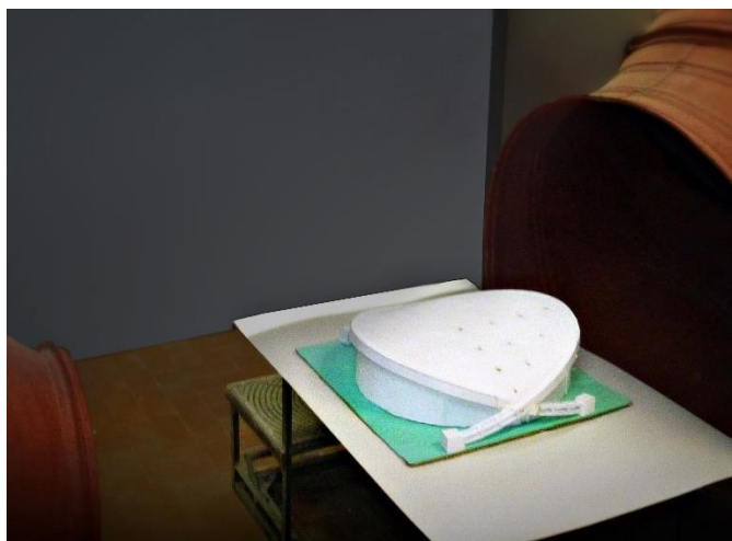
Рис. 2.4 а) Макет здания, помещенный в аэродинамическую трубу. б) Схема размещения дреназирующих трубок на покрытии макета с указанием направлений ветровых потоков, принятых при моделировании
