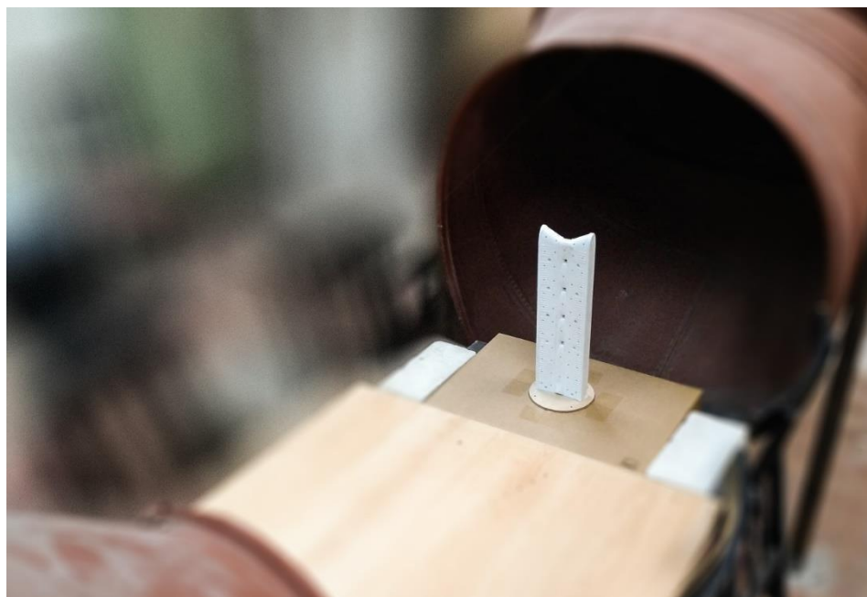
Рис. 3.22. Макет здания в аэродинамической трубе
