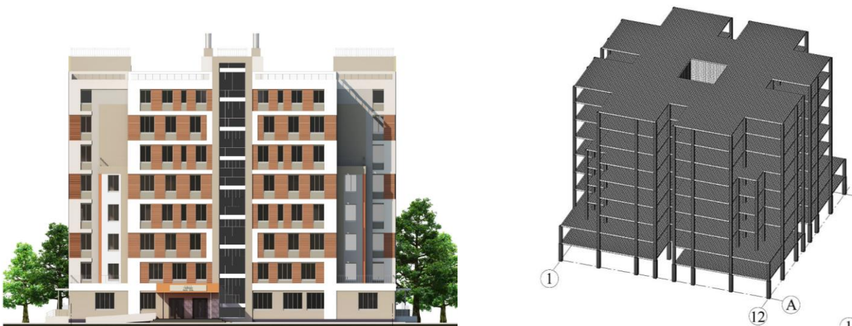
Рис. 4.1. Проектируемое каркасное здание фасад, пространственная конечно-элементная модель
