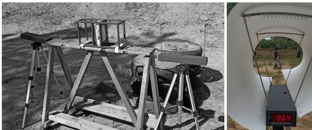
Рисунок 2.12 – Испытание на удар с использованием хронографов
