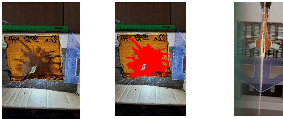
Рисунок 2.37 – Площадь межслойных дефектов при реальных испытаниях
