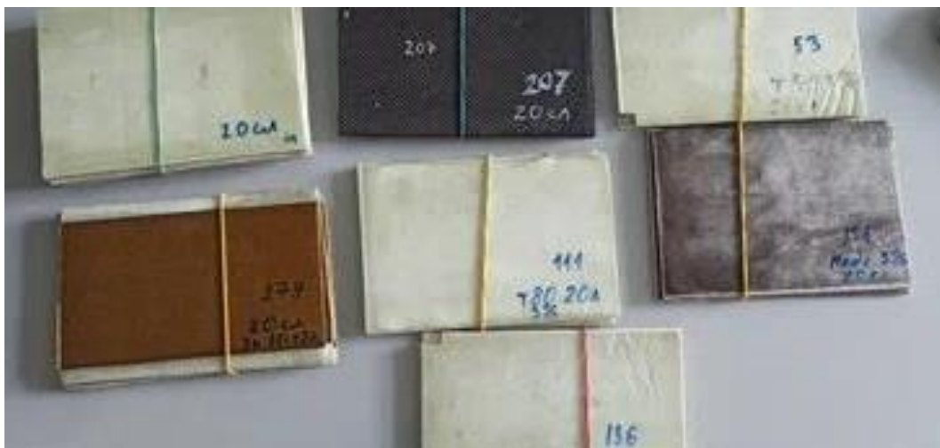
Рисунок 2.3 – Изготовленные образцы для проведения испытаний на низко- и высокоскоростной удар
