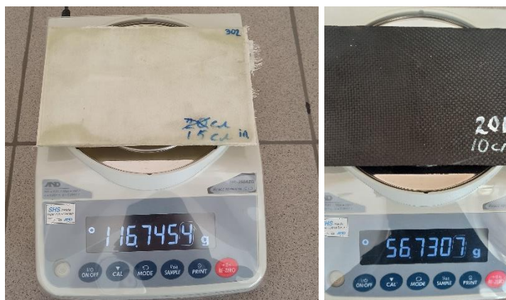
Рисунок 2.2 – Вес пластины из стеклопластика (15 слоев) и углепластика (10 слоев)
