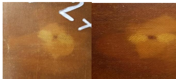
Рисунок 4.1 – Повреждение стеклопластика из 20 слоев при низкоскоростном ударе
