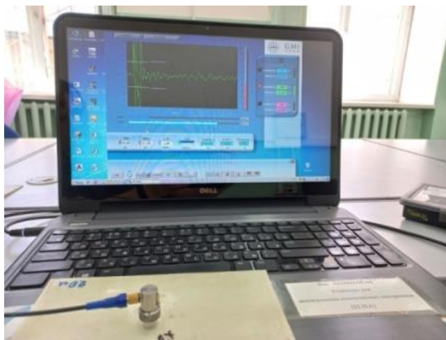
Рисунок 5.1 – Комплекс для ультразвуковой дефектоскопии КМ ELISA GMIUC002-14
