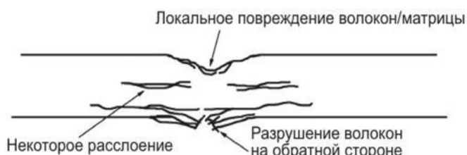
Рисунок 4.1 – Повреждение стеклопластика из 20 слоев при низкоскоростном ударе
