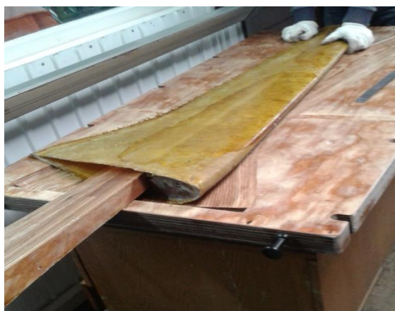
Рисунок 3.23 – Консоль крыла из стеклопластика
