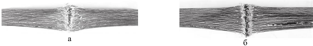
Рисунок 1.9 – Образец из стеклопластика, на котором видно расширение отверстия и пробитие коническим ударником весом 13,2 г: а – удар со скоростью 203 м/с под углом 37^\circ в вершине образца; б – удар со скоростью 384 м/с под углом 120^\circ в вершине образца
