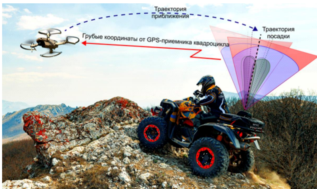
Рисунок 1 – Применение автоматической радиосистемы посадки БЛА на движущийся объект
