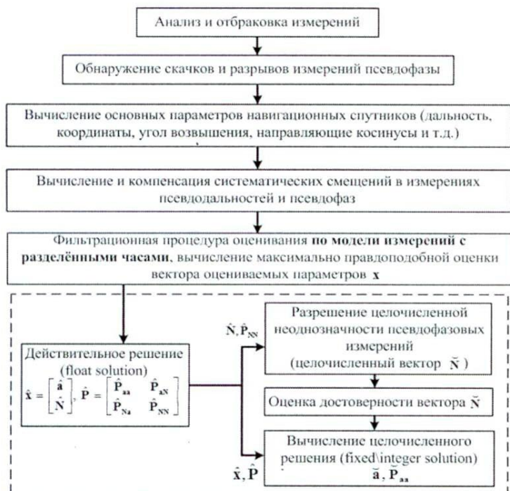
Рис. 3. Укрупненная блок-схема алгоритма местоопределения в режиме Integer PPP
