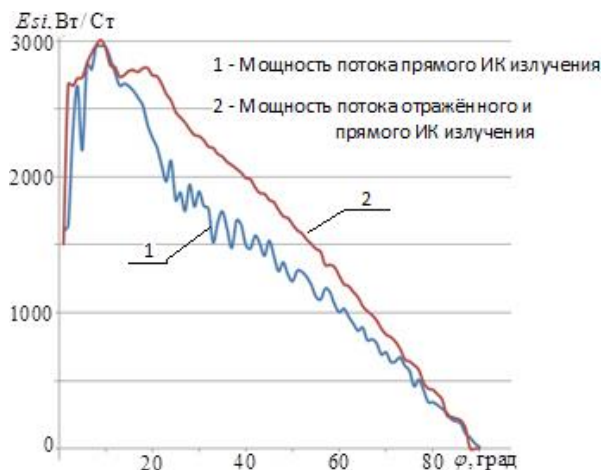
Рис. 10. Индикатриса излучения ДУ АЛ-31Ф
