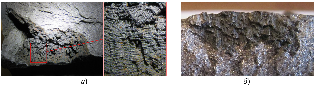
Рисунок 3.4 – Фрактограммы боковой поверхности ГТ, выявленные в отливках:
