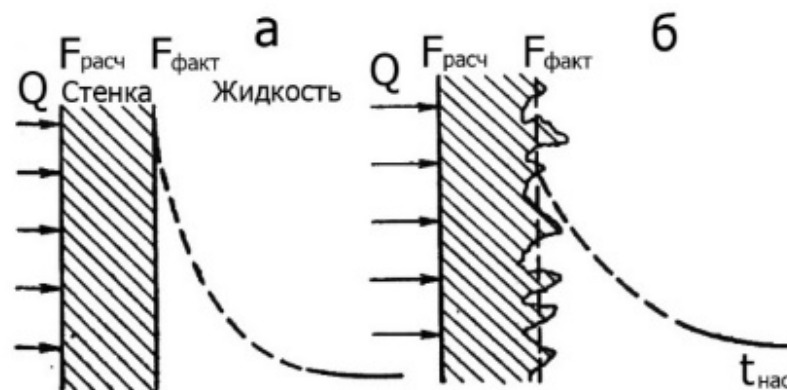
Рисунок 4.11 – Характер изменения температур вблизи стенки: а – идеально
