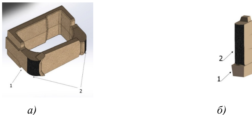
Рисунок 5.7 – Места локального нанесения функционального покрытия (позиция 2) на стержнях (позиция 1), применяющихся при изготовлении отливок: а – «Рама боковая»; б – «Корпус автосцепки»
