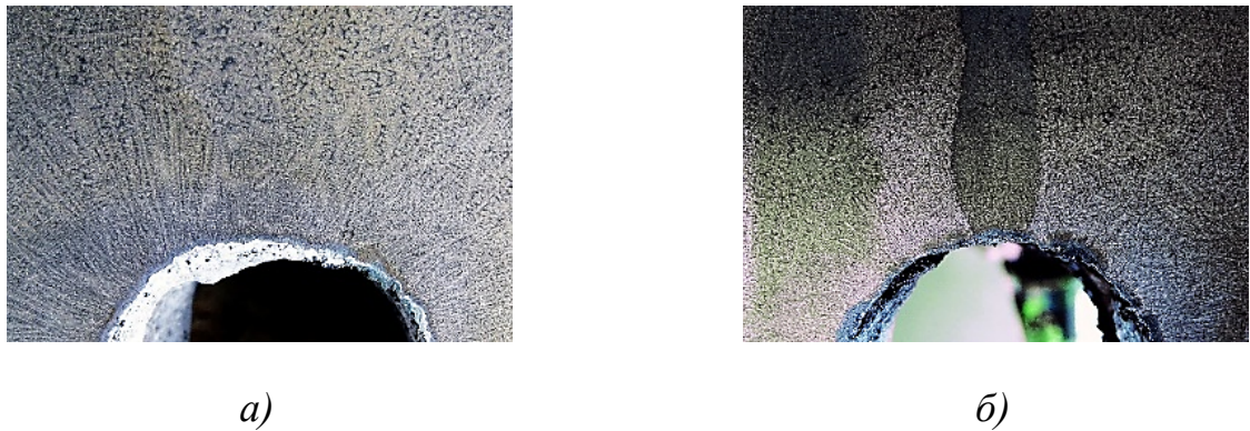
Рисунок 5.10 – Фотографии макроструктуры образцов в зоне отливки «Корпус автосцепки», с повышенной склонностью к образованию ГТ (R18), \times 2 : а – обычная технология изготовления; б – с использованием искусственно созданного микрорельефа на поверхности (травлено)
