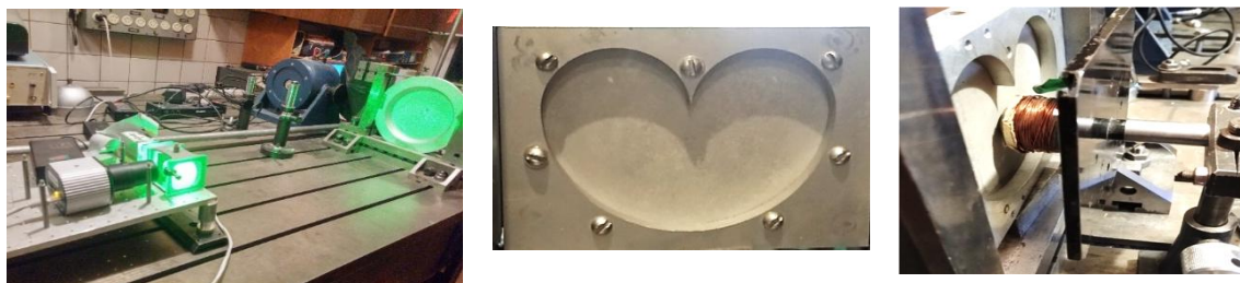
Рисунок 4.8 – Оптико-акустический стенд: слева - оптический блок, в центре - один из образцов, справа - часть акустического блока для возбуждения и регистрации резонансных частот колебаний с тыльной стороны образца
