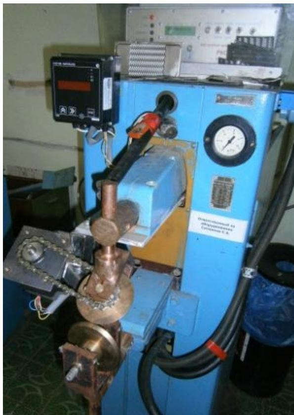
**Рисунок 29 - Машина точечной сварки МТ 604, переоборудованная для осуществления роликовой шовной импульсной шаговой сварки**
