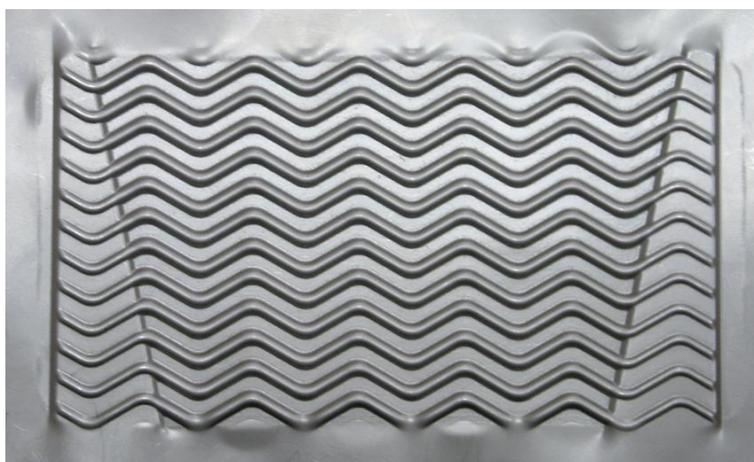
**Рисунок 22 - Вариант пластины, полученные штамповкой эластичной средой**
