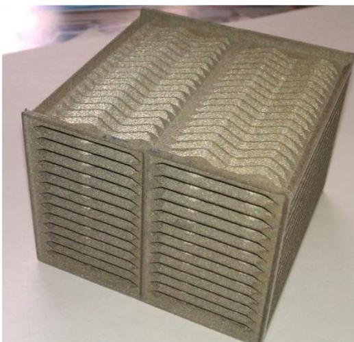
**Рисунок 34 – Объект экспериментального исследования – теплообменный аппарат**
