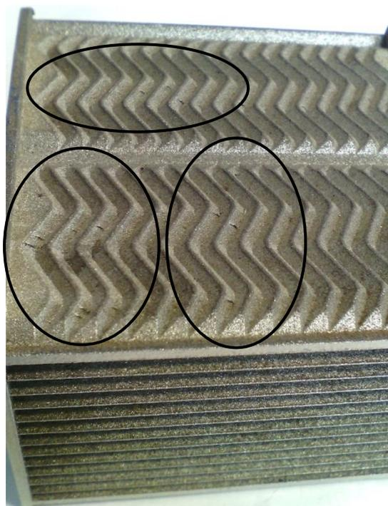
**Рисунок 40 – Дефекты изготовления, выявленные при испытании образца
