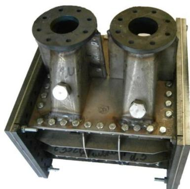
**Рисунок 33 – Теплообменный аппарат в сборе**
