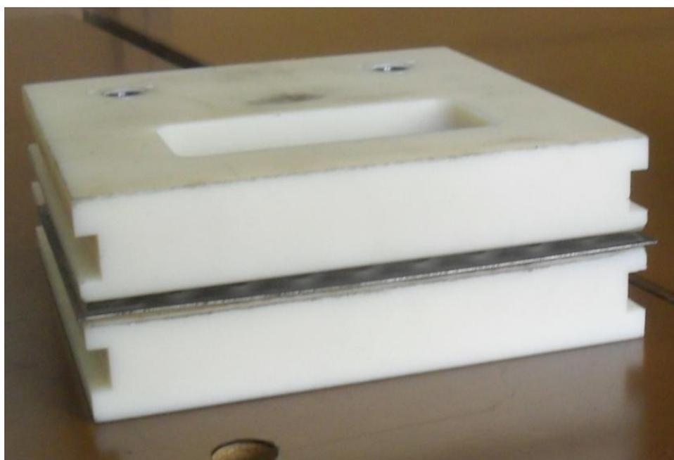
**Рисунок 28 – Приспособление формы для сварки пластин (ложемент)**
