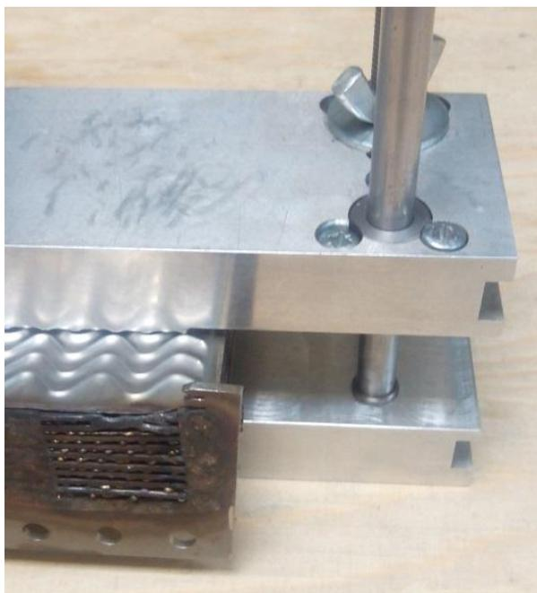
**Рисунок 32 – Кондуктор для сварки угловых элементов теплообменной матрицы между собой и фланцем**
