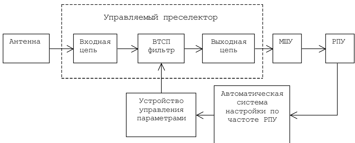
Рисунок 1 – Использование ВТСП фильтра в качестве преселектора радиоприемного устройства.
