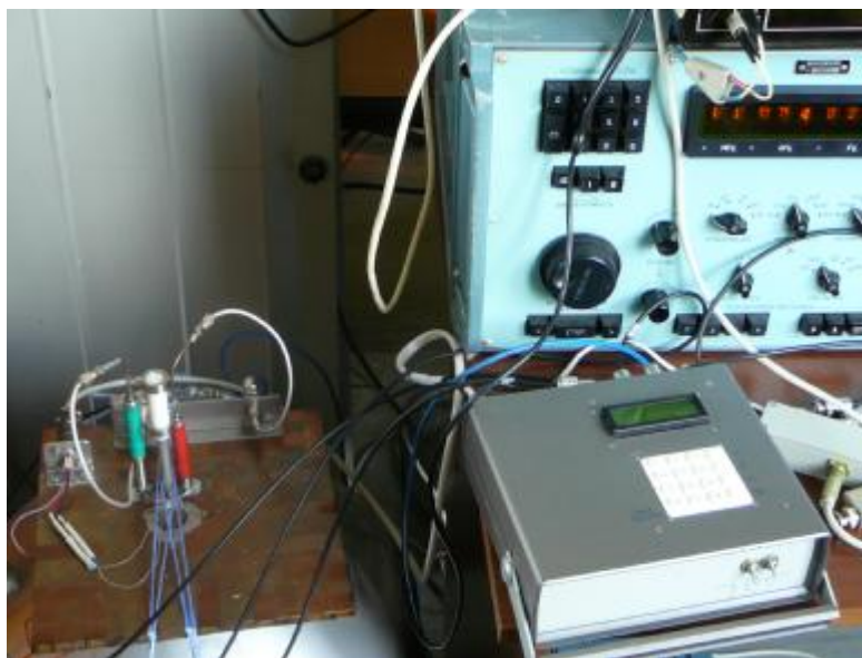
Рисунок 10 - Фотография испытательного стенда системы преселектор + система управления + РПУ.
