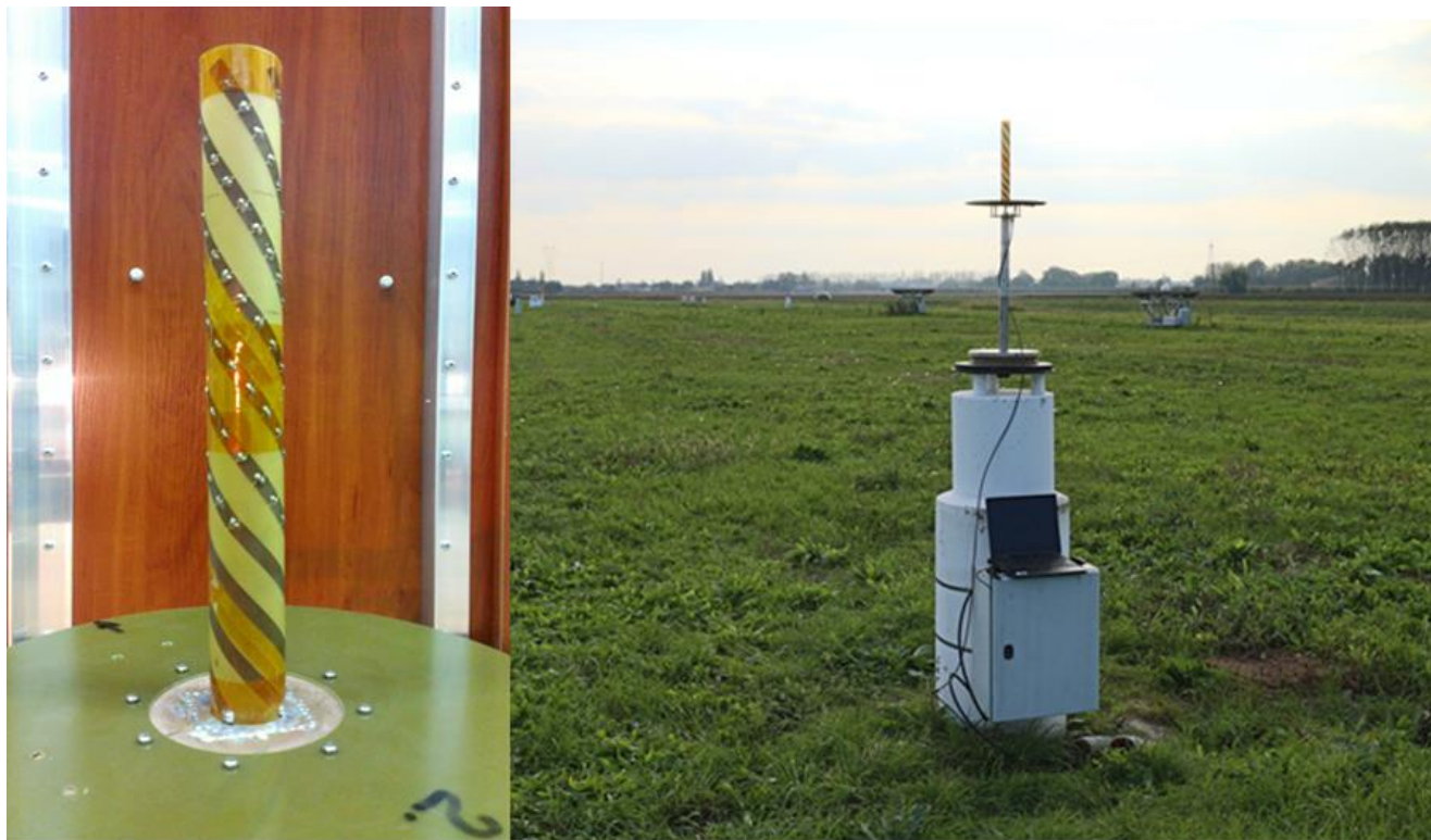
Рис. 1.3. Общий вид спиральной антенны (слева) и антенны, установленной на полигоне (справа)
