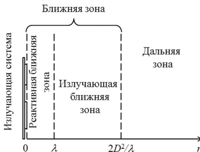
Рисунок 1.1 – Зональная структура электромагнитного поля источника излучения с линейным размером D для длины волны \lambda в зависимости от расстояния r .
