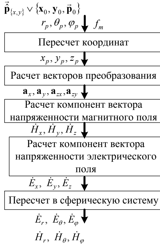
Рисунок 4.5 – Алгоритм расчёта характеристик ЭМИ в дальней зоне.
