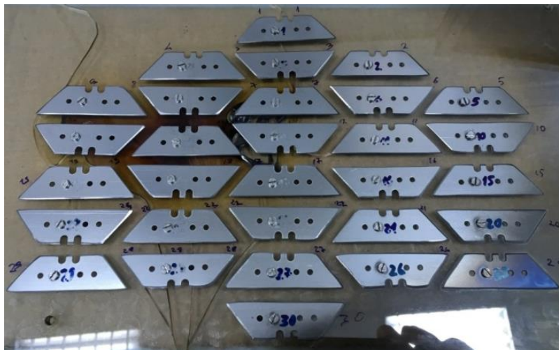
Рисунок 5.47 – Результат воздействия ионного пучка на набор масок
