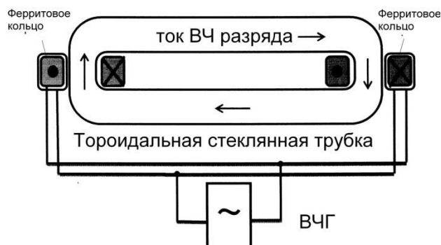
Рисунок 1.22 – ВЧИ-газоразрядная ячейка в замкнутой трубке с использованием замкнутых ферритовых сердечников [71]
