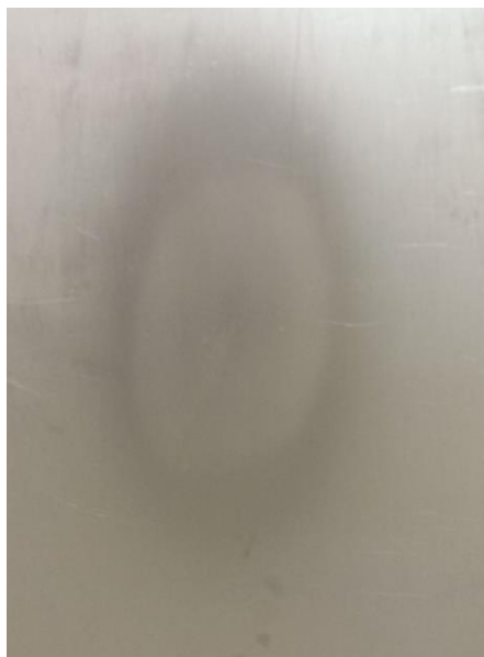
Рисунок 5.45 – Укрупнённое изображение следа ионного распыления на титановой мишени системой ВЧИИП-10Ф со щелевыми электродами
