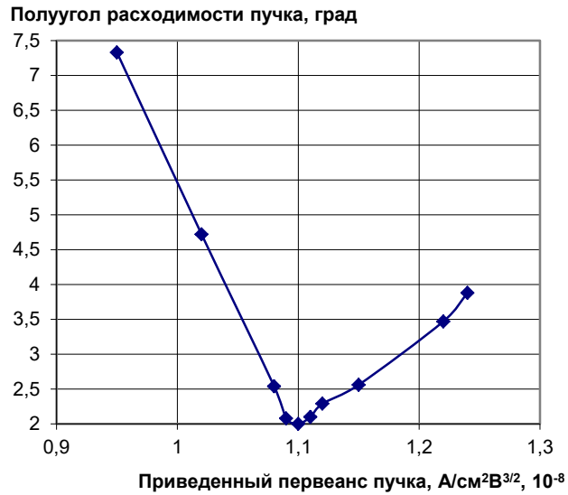
Рисунок 5.11 - Зависимость полуугла расходимости пучка от приведенного первеанса пучка расчета рисунка 5.10
