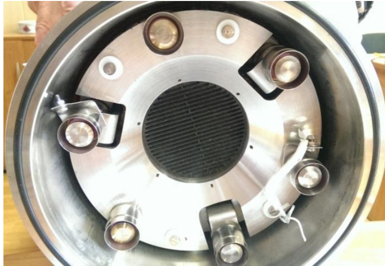
Рисунок 5.31 – ИОС, установленная на ВЧИИП-10Ф
