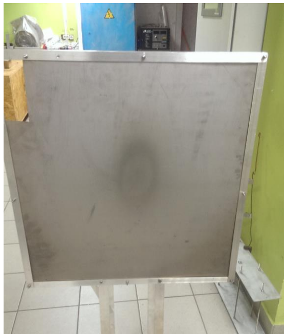
Рисунок 5.44 – Внешний вид титановой мишени после нескольких часов воздействия на неё ионным пучком ВЧИИП-10Ф
