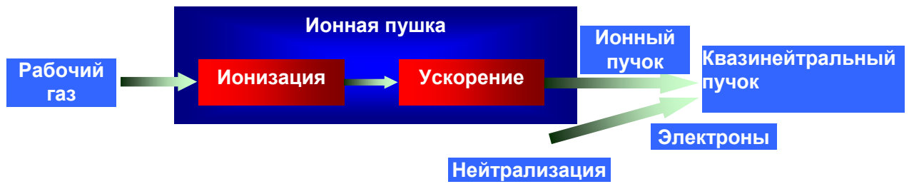
Рисунок 1.1 – Принципиальная схема ИИП (источника ионного пучка)
