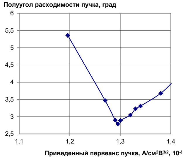
Рисунок 5.9 – Зависимость полуугла расходимости пучка от приведенного первеанса пучка расчета рисунка 5.8
