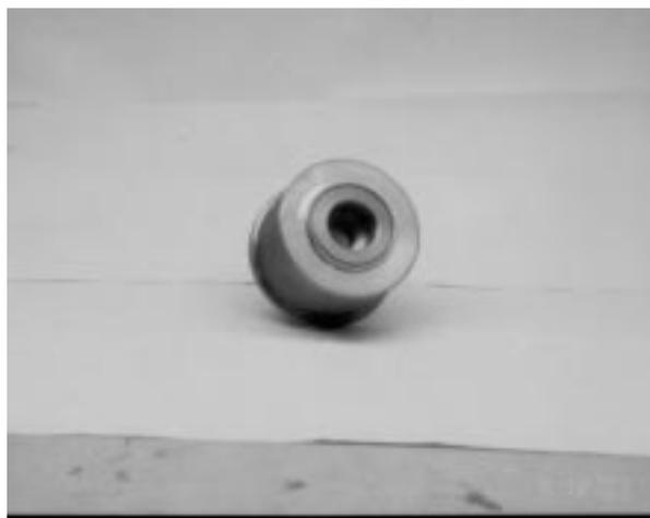
Рис. 6. Общий вид сопла плазмотрона с вставкой из тугоплавкого металла
