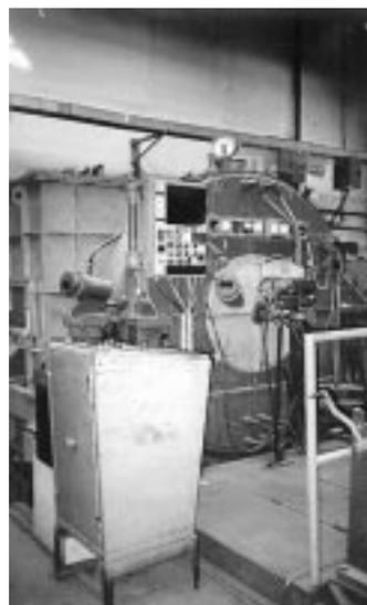
Рис. 3. Установка центробежного распыления УЦР- 4
