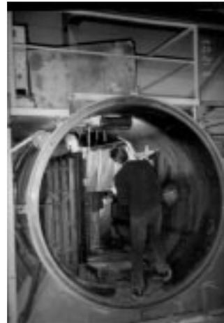
Рис. 9. Установка для дегазации гранул, засыпки их в капсулы и заварки
