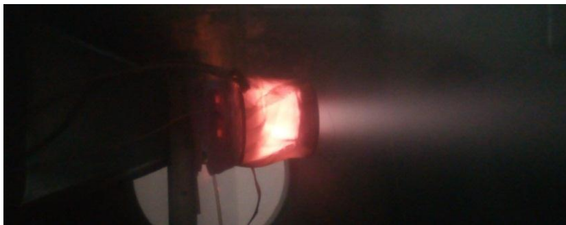
Рисунок 7 – Пучок ионов при потенциале эмиссионного электрода +600 В.
