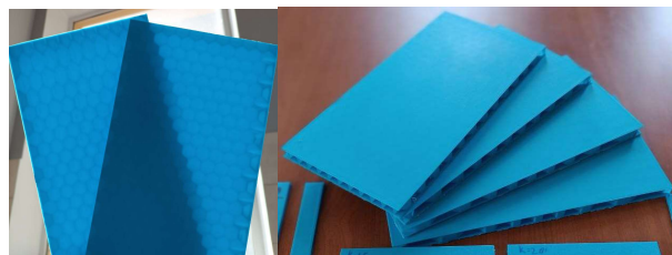
Рис. 3. Образцы для испытаний с размерами 300 мм на 150 мм
