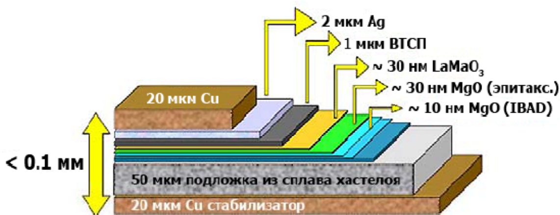
Рисунок 1.21. Структура композитного ленточного ВТСП провода 2-ого поколения
