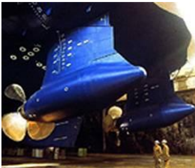
Рисунок 1.5. Размещение приводного двигателя в поворотной гондоле под днищем корпуса
