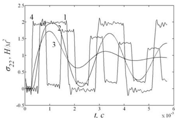
Рис. 18. 1 – упругое ГЭ-решение, ГЭ-решение для модели стандартного вязкоупругого тела 2 –  $\gamma = 200$ , 3 –  $\gamma = 50$ , 4 –  $\gamma = 1$ .
