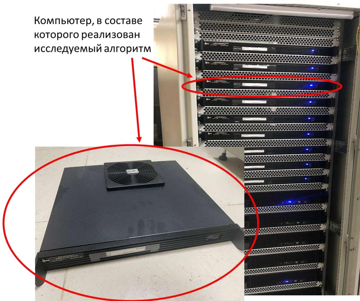
Рисунок 4. Стойка с размещенными в ней промышленными компьютерами испытательного стенда
