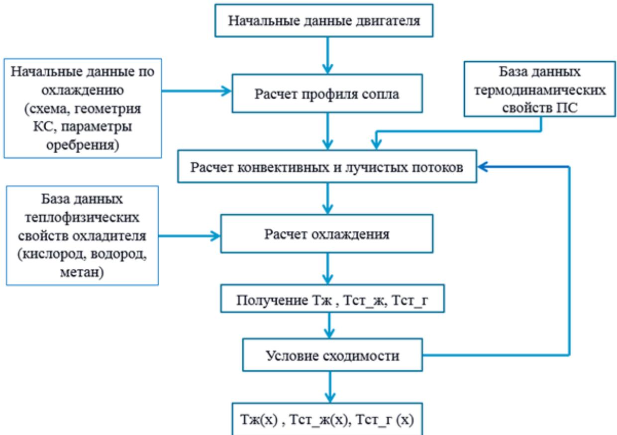
Рисунок 2.1. – Укрупнённая блок-схема расчёта охлаждения двигателя
