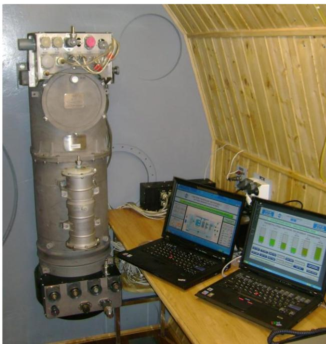
Рис. 8: Тренажер системы «ЭЛЕКТРОН-ВМ»
