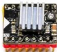
Рисунок 4 – Внешний вид драйвера шагового двигателя (ДШД).
