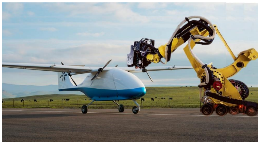
Рисунок 1– Пример использования РАТЗ для заправки БЛА
