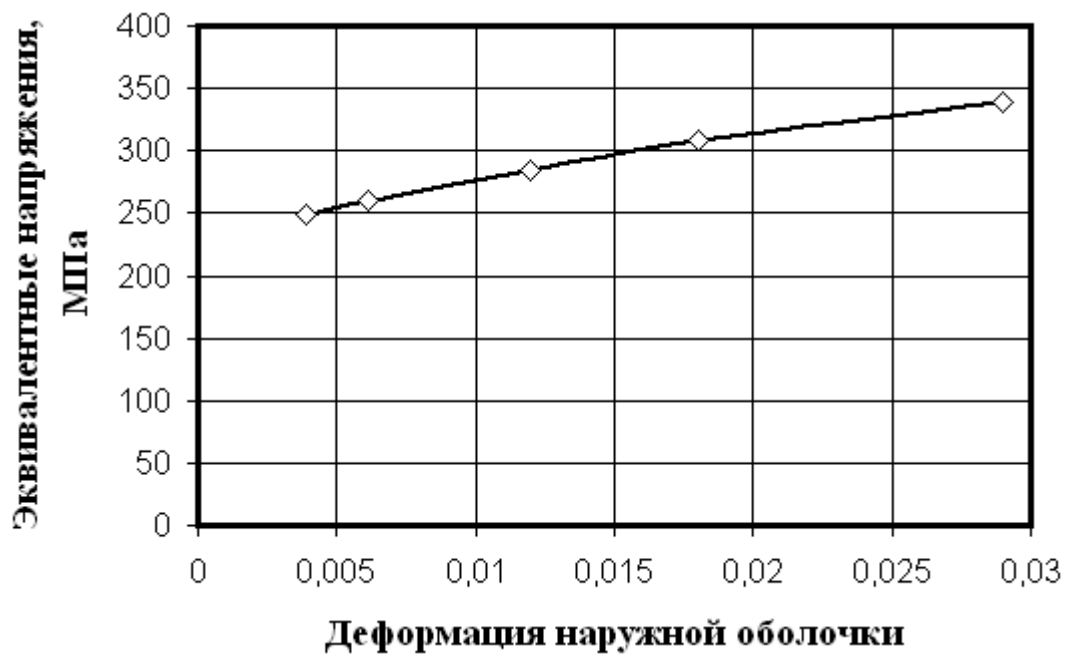
Рисунок 3.26 - Влияние максимальной деформации на эквивалентные напряжения в наружной оболочке.
