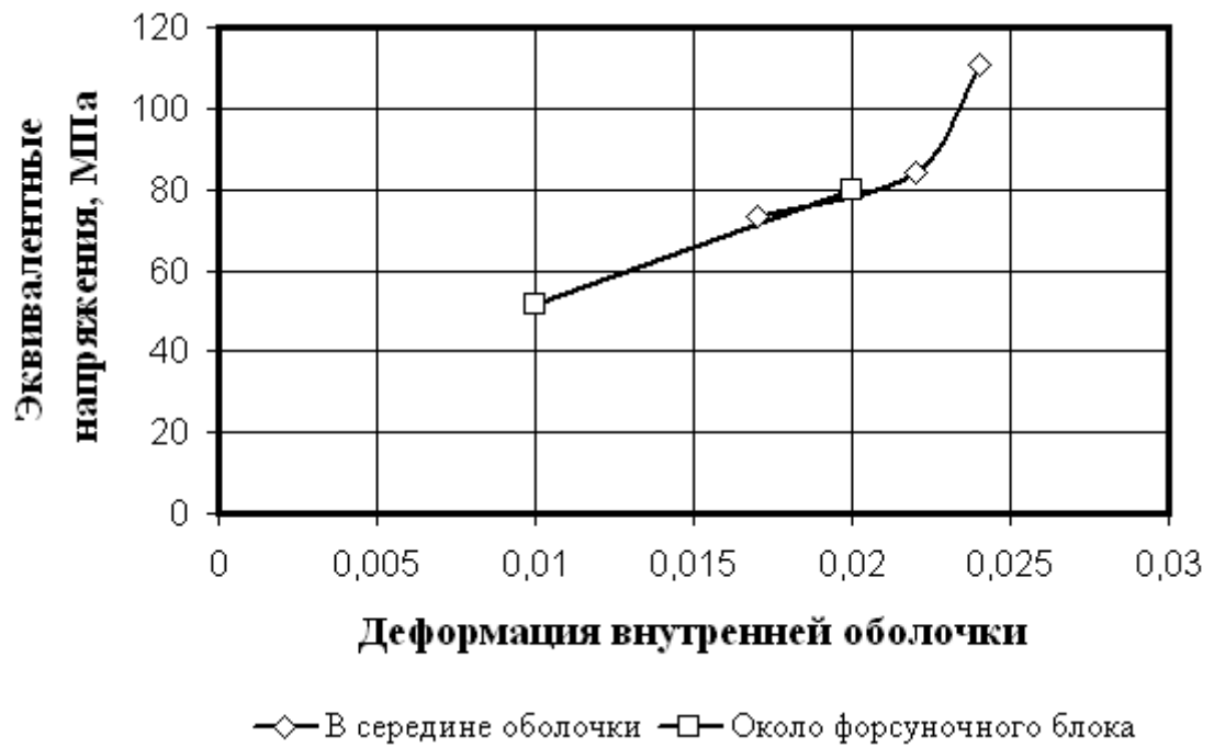
Рисунок 3.25 - Влияние максимальной деформации на эквивалентные напряжения внутренней оболочки.
