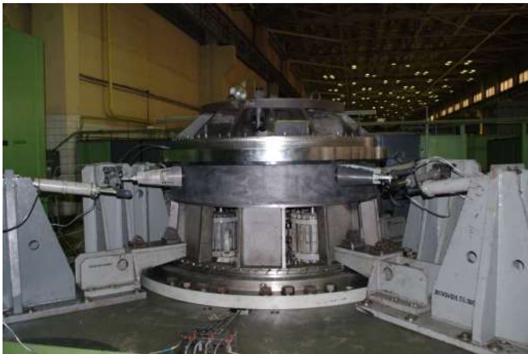
Рисунок 4.7 – Стенд с установленными технологическими плитами для создания осевых сил
