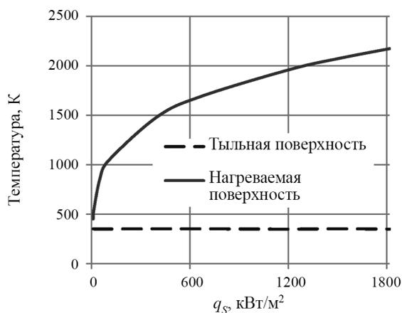
Рис. 5. Температура нагреваемой и тыльной поверхности экрана в зависимости от плотности теплового потока солнечного излучения  $q_s$
