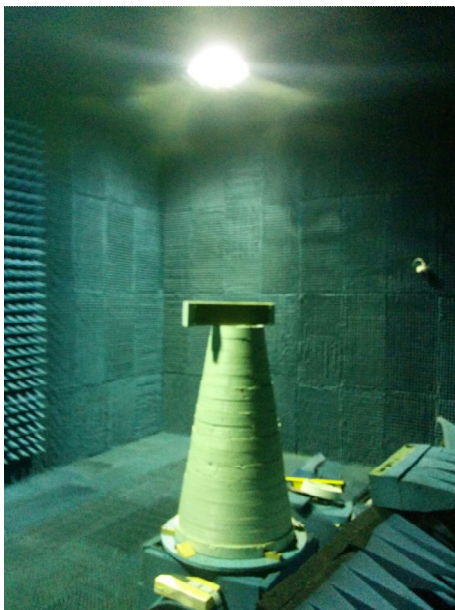
Рисунок 2.38 – Макет ЛПС L-диапазона, экранированной ЧСС.
