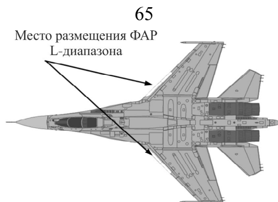
Рисунок 2.17 – Размещение системы излучения линейной ФАР L-диапазона на ЛА
