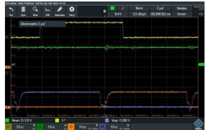
Рисунок 20 – Осциллограмма экспериментальных исследований Желтый – входной сигнал управления драйвера;
