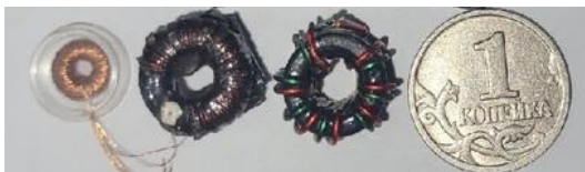
Рисунок 7 – Фотография трансформаторов, используемых в качестве ТГР для драйверов
