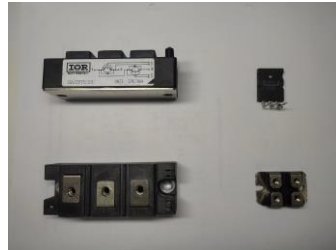
Рисунок 18 – Высоковольтные IGBT транзисторы и MOSFET
