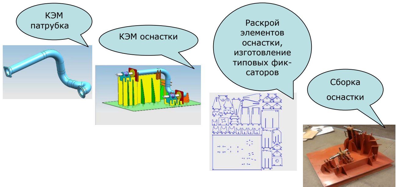
Рисунок 3 – Общая схема проектирования и изготовления приспособления
