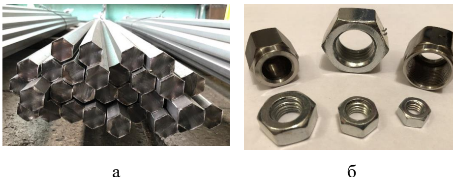
Рисунок 4.15 - Шестигранные прутки (а) и гайки (б) различной конструкции из сплава ВТ16
