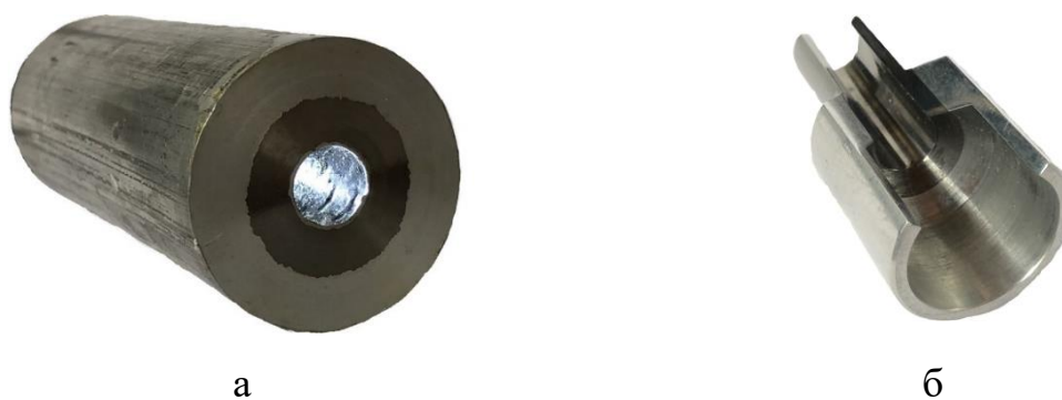
Рисунок 4.6 - Отрезок биметаллической трубы (а) и переходник (б)
