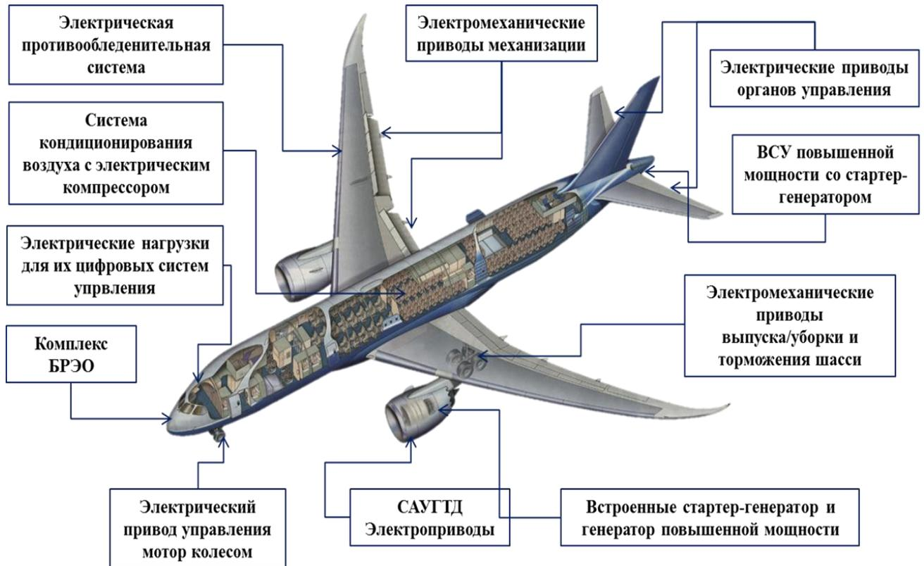
Рисунок 1.2 – Основные системы полностью электрического самолета
