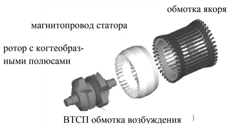
Рисунок 1.11 – ВТСП-генератор с когтеобразными полюсами
