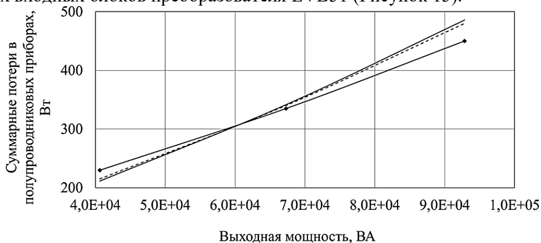
Рисунок 15 – Результаты исследования суммарной мощности потерь в IGBT приборах входных блоков
