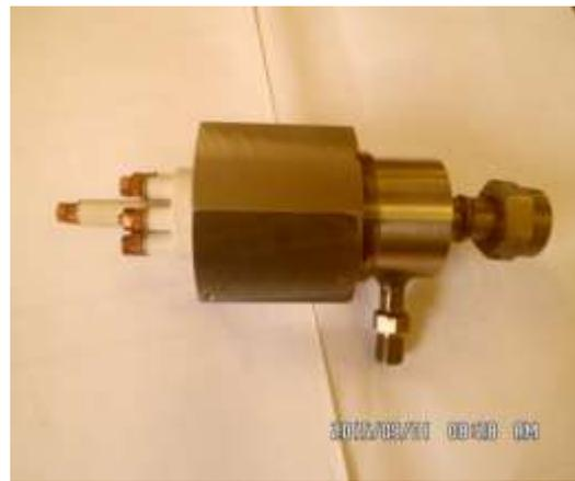
Рис. 15 - Фотография многоимпульсного ЭИВУ
