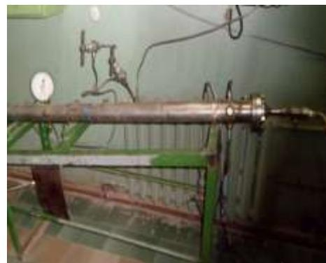
Рис. 10. Фотография трубы высокого давления (ударной трубы) с присоединённым к ней ВУ
