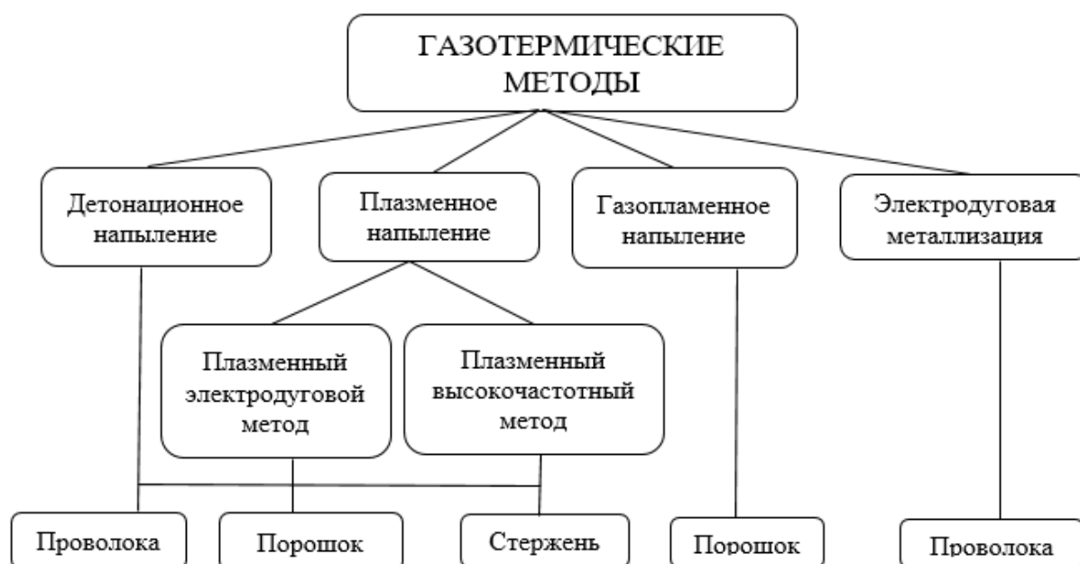
Рисунок 1.1. Классификация газотермических методов нанесения покрытий
