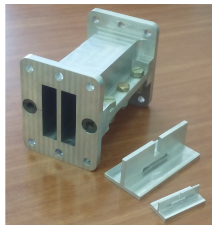
Рисунок 3.18 – Волноводный Т-щелевой НО: а) – конфигурация модели НО для анализа МКЭ; б) – изготовленные макетные образцы, слева направо показаны: НО S -диапазона; фрагмент НО S -диапазона; фрагмент НО X -диапазона.
