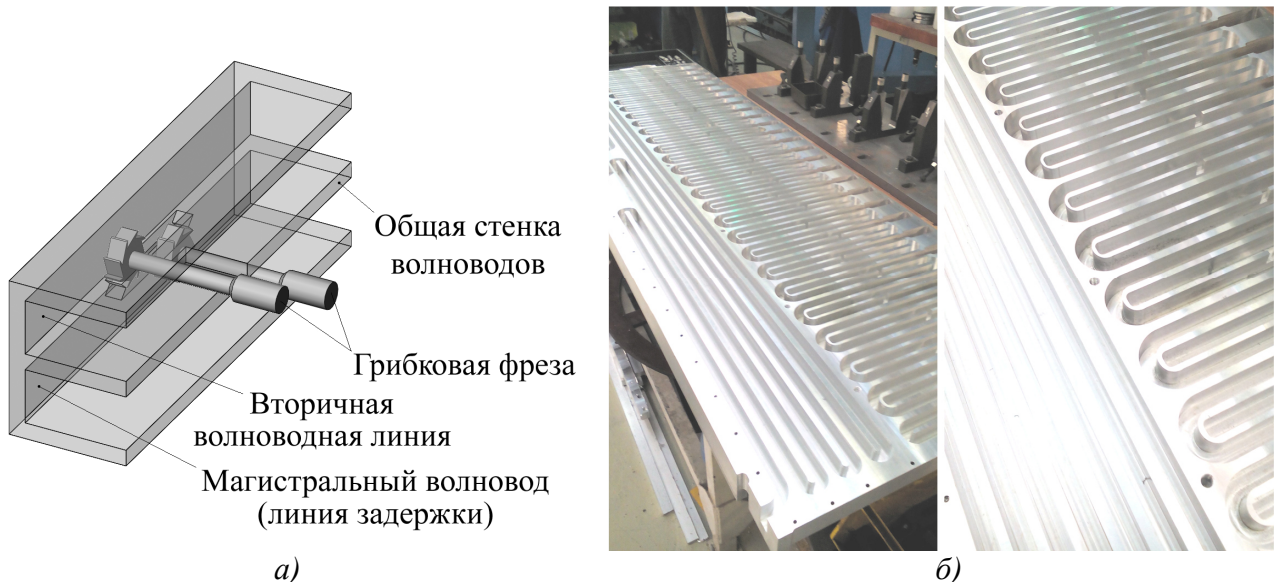
Рисунок 4.11 – Изготовление составных частей ДКС: а) – фрезерование продольных щелей НО; б) – изготовленные фрезерованные плиты ДМ-27-1.
