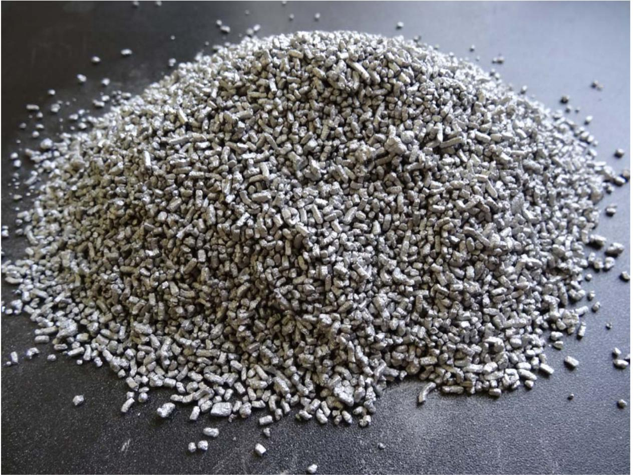
Рисунок 6.24 - Вид гранулированного порошка ПАП-2 после проведения технологической операции 3.
