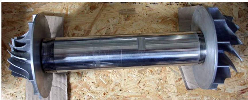
Рисунок 21. Колеса детандера и компрессора с валом.
