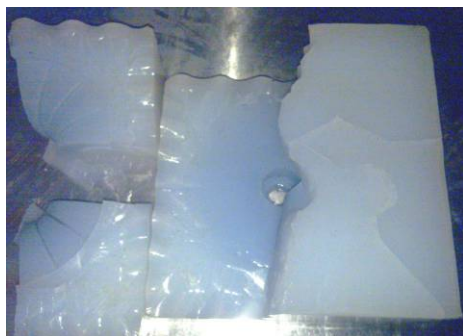
Рисунок 18. Силиконовая форма для колеса детандера.
