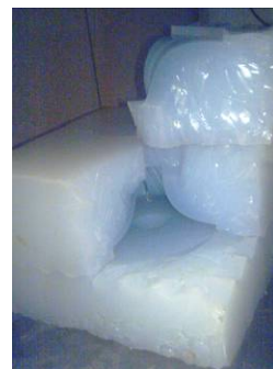
Рисунок 18. Силиконовая форма для колеса детандера.
