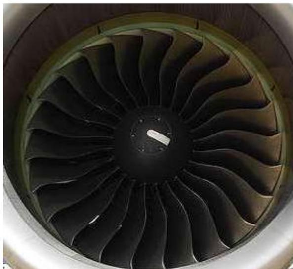
Рис.3. Вентилятор компрессора низкого давления.
