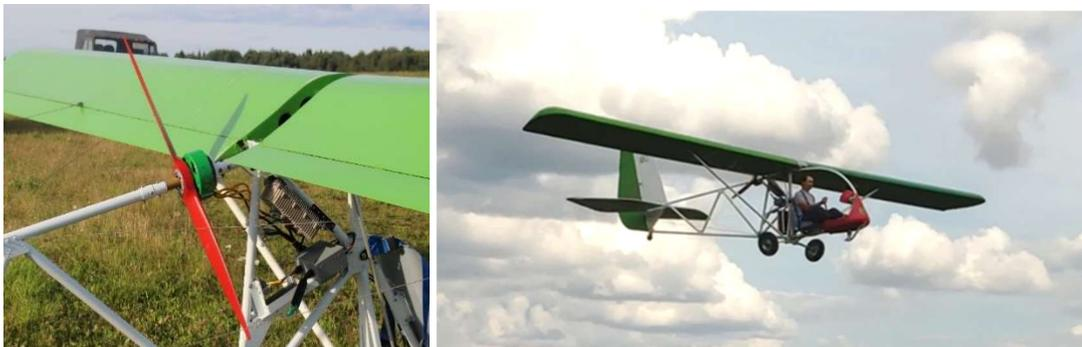
Рисунок 11. Компановка ЭВМГ и экспериментальный самолёт в полёте
