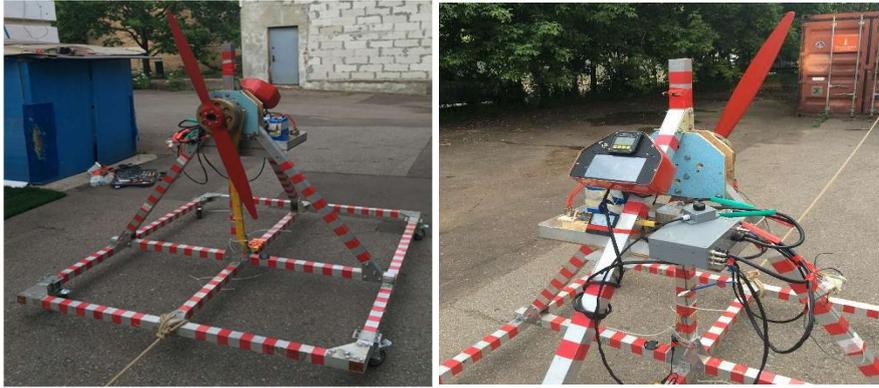
Рисунок 9. Общий вид стенда №1 для испытания ЭВМГ
