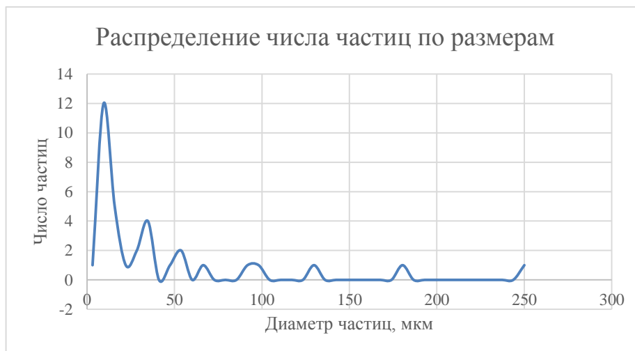
Рисунок 3.4.23 Форсунка 3. Мгновенное распределение частиц по размерам.
