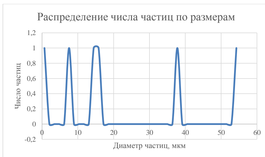
Рисунок 3.4.1 Форсунка 1. Мгновенное распределение частиц по размерам.
