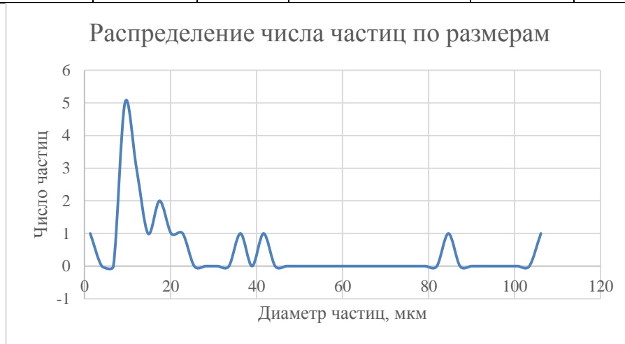
Рисунок 3.4.22 Форсунка 2. Мгновенное распределение частиц по размерам.
