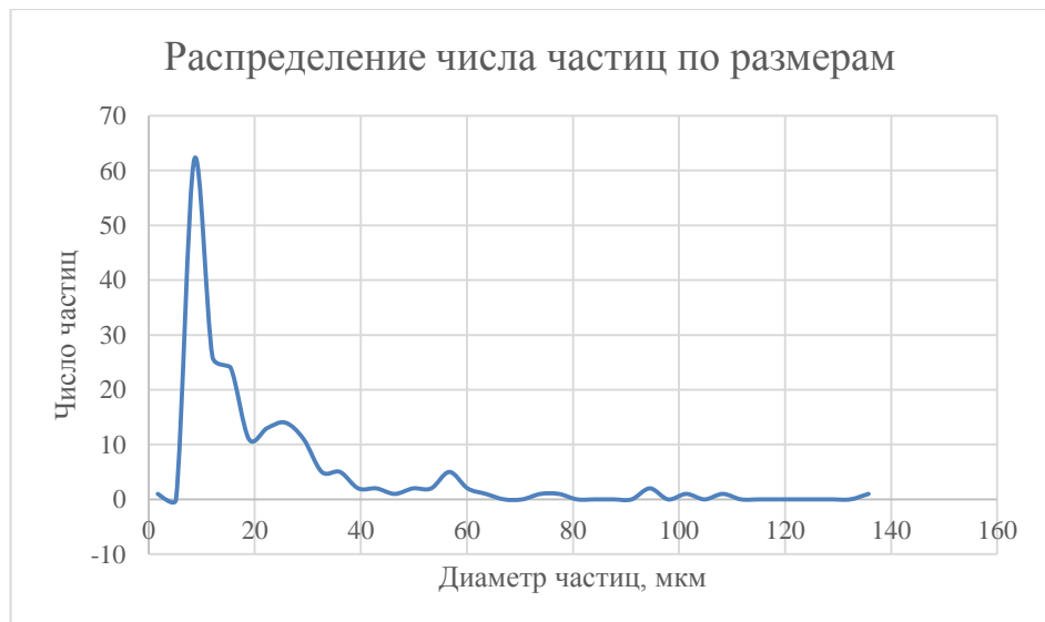
Рисунок 3.4.21 - Форсунка 29. Мгновенное распределение частиц по размерам.
