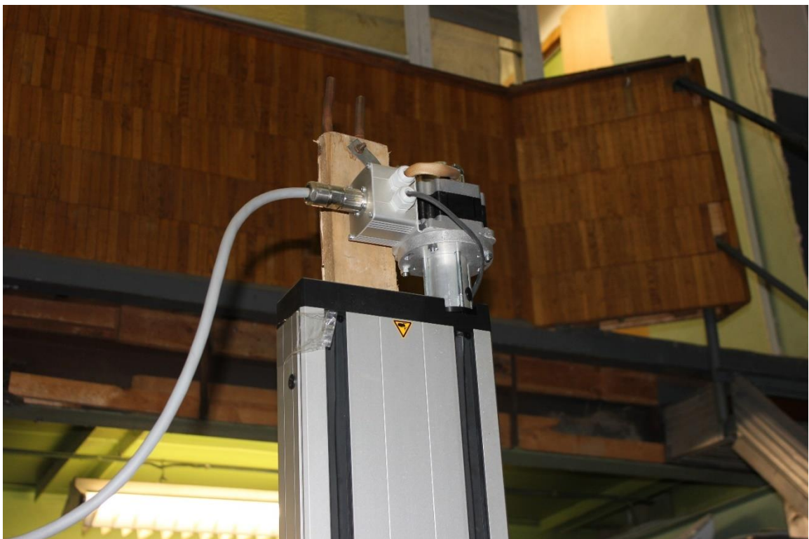
Рисунок 2.6.2 – Электрический привод вертикального перемещения объекта. Управляется от компьютера
