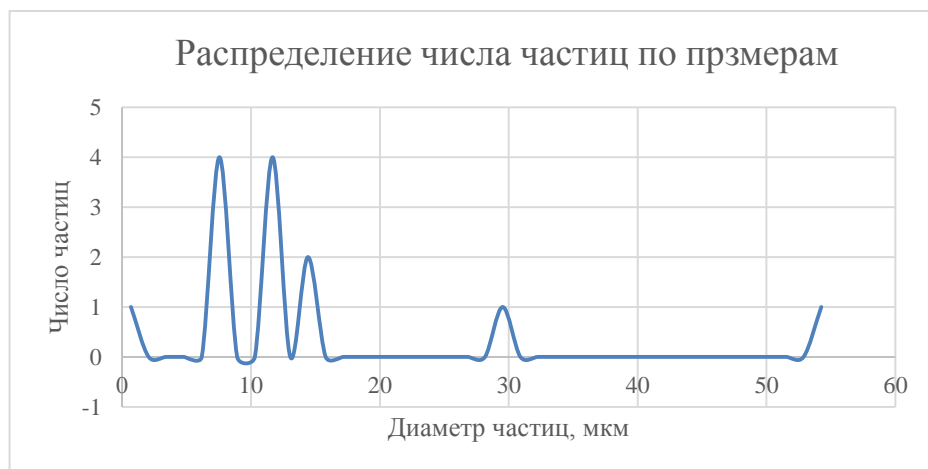
Рисунок 3.4.15 Форсунка 2. Мгновенное распределение частиц по размерам. Порог 40.
