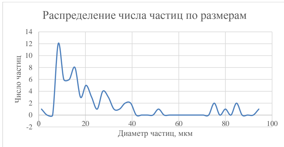
Рисунок 3.4.24 Форсунка 13. Мгновенное распределение частиц по размерам.
