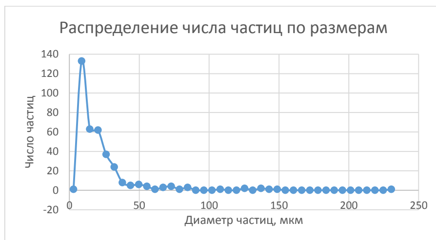
Рисунок 2.7.7 График распределения числа частиц по размерам с экспериментально полученными точками. Форсунка 28, расстояние от среза 5 - 10 мм, режим 2
