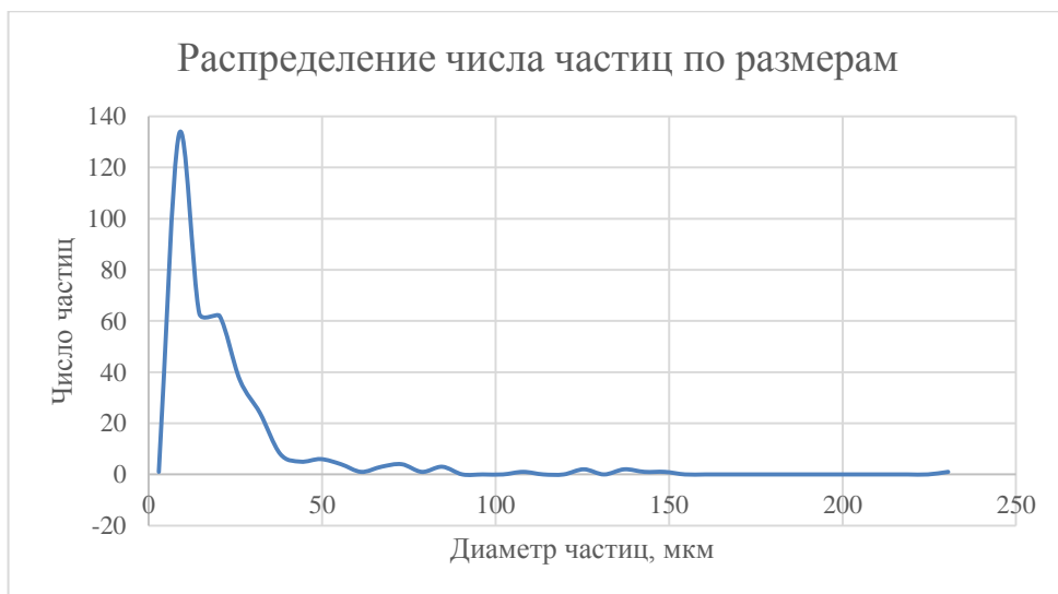
Рисунок 3.4.6 Форсунка 28. Мгновенное распределение частиц по размерам.
