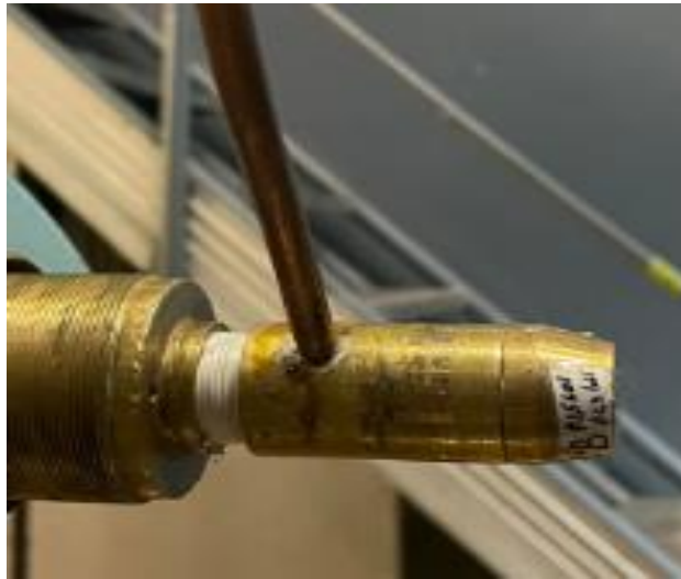
Рисунок 2.1.7 Устройство для отбора давления и форсунка.
