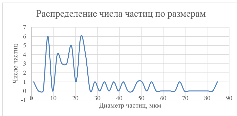
Рисунок 3.4.18 Форсунка 13. Мгновенное распределение частиц по размерам
