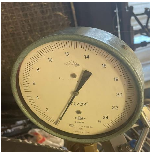
Рисунок 2.1.6 Манометр ГОСТ 6400-69 на входе в объект исследования
