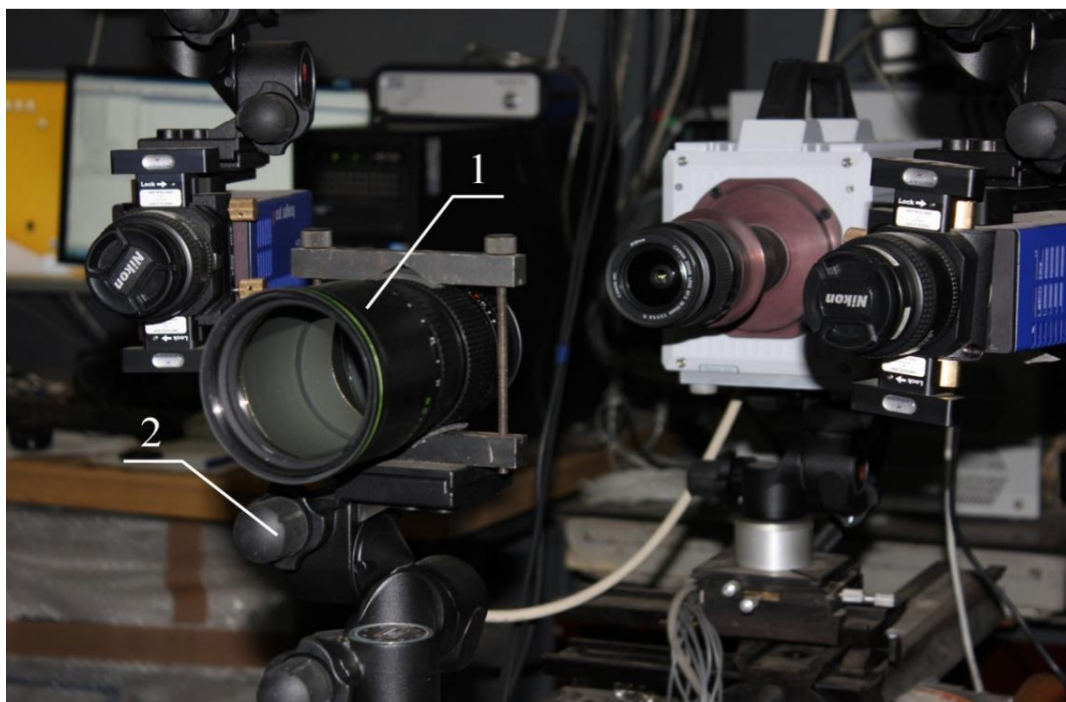
Рисунок 2.6.7 - Фотография цифровой видеокамеры с дополнительным объективом Юпитер 36-Б 3.5/250
