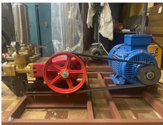
Рисунок 2.2.4 Насос "Vodotok" YY-150 и электродвигатель АИР 160 S2 IM1001
