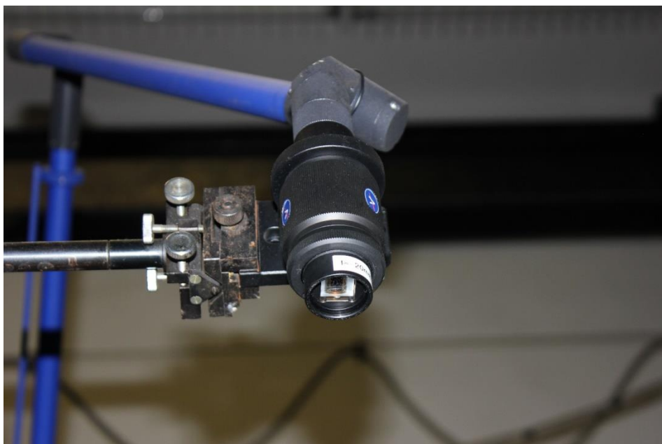
Рисунок 2.6.4 Оптическая система создания лазерного «ножа». Объектив и цилиндрическая линза
