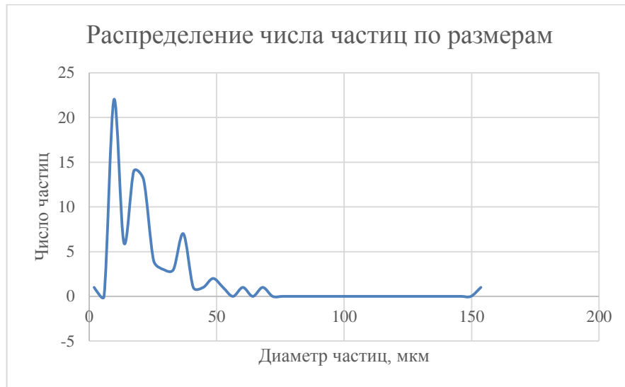
Рисунок 3.4.12 Форсунка 28. Мгновенное распределение частиц по размерам.
