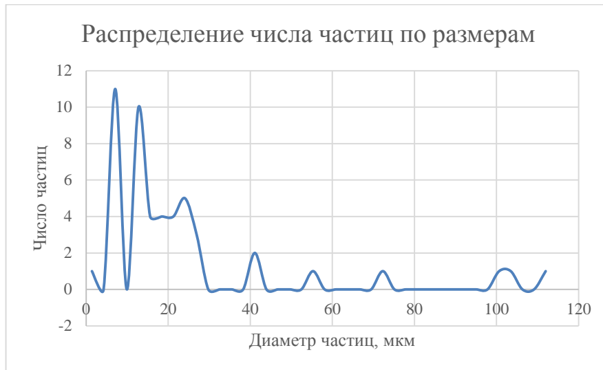
Рисунок 3.4.5 Форсунка 14. Мгновенное распределение частиц по размерам.
