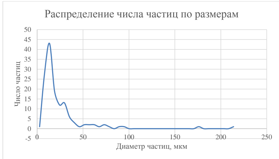
Рисунок 3.4.14 Форсунка 2. Мгновенное распределение частиц по размерам. Порог 32.
