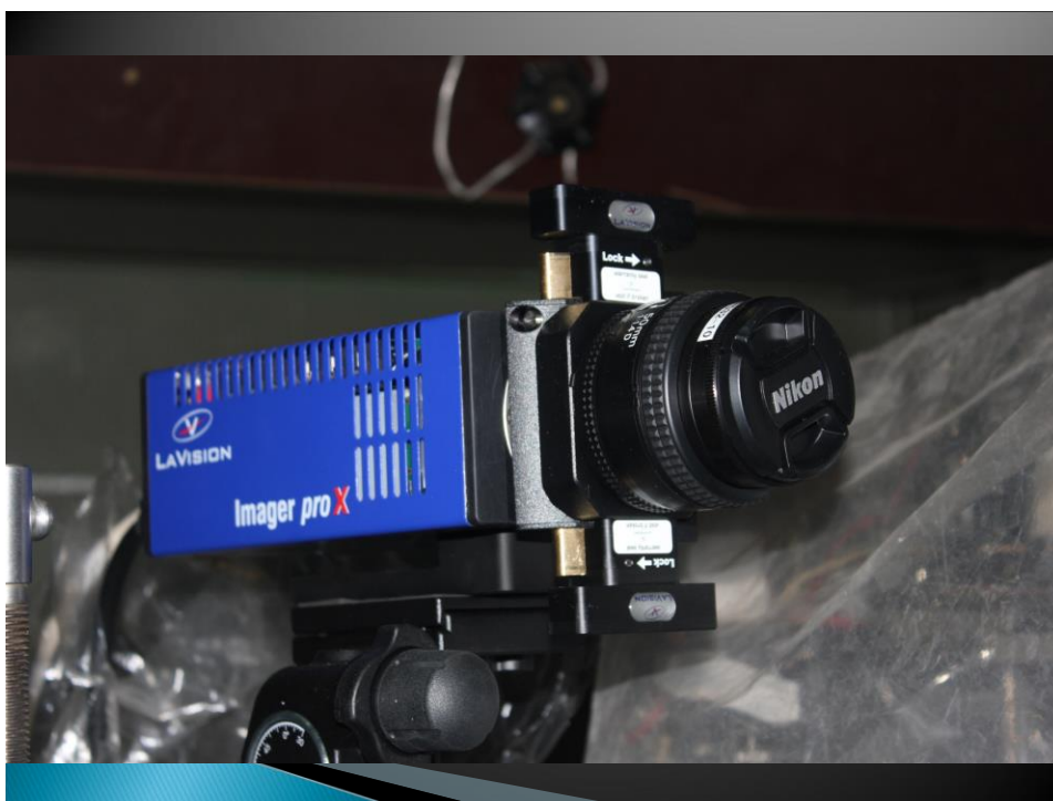
Рисунок 2.4.2 - Кросскорреляционная видео камера с Шеймпфлюг-узлом
