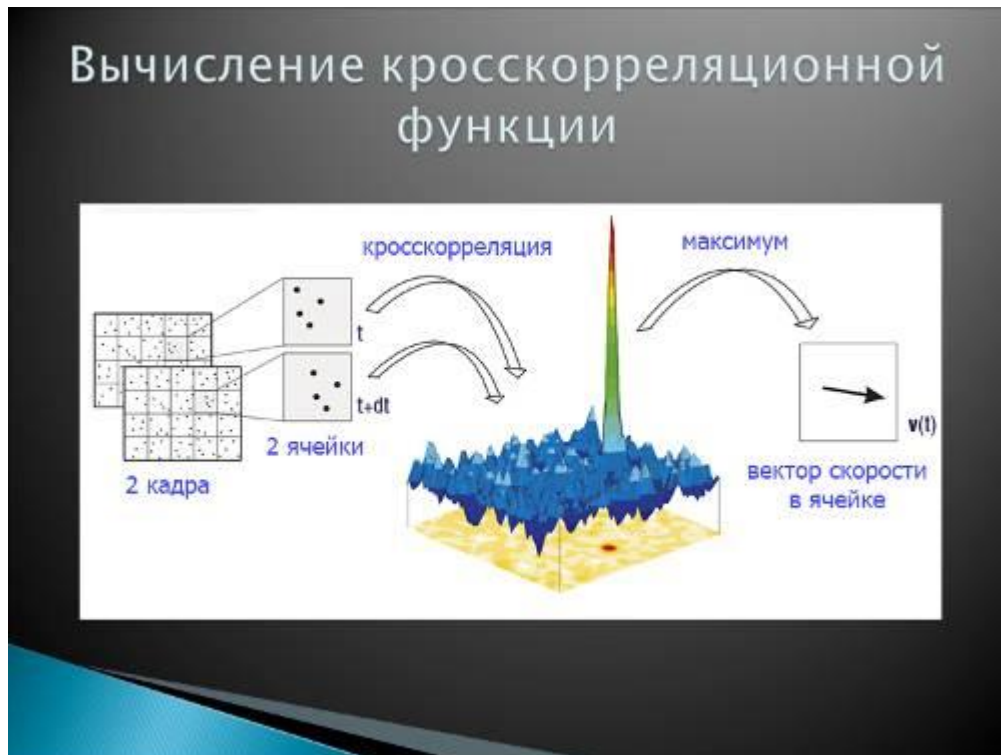
Рисунок 2.3.5 Вычисление кросскорреляционной функции в ячейке
