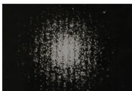
Рисунок 2.3.2 - Двухэкспозиционное изображение потока, пространственный спектр и корреляционная функция при высокой концентрации частиц
