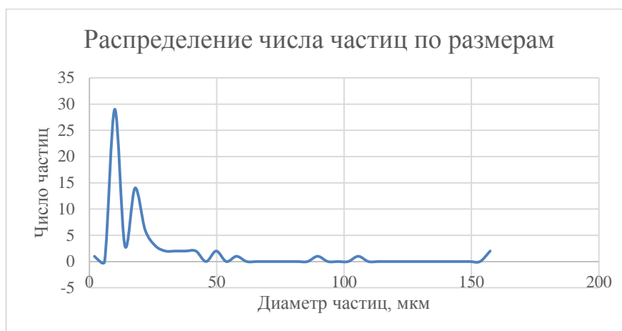
Рисунок 3.4.9 Форсунка 3. Мгновенное распределение частиц по размерам.
