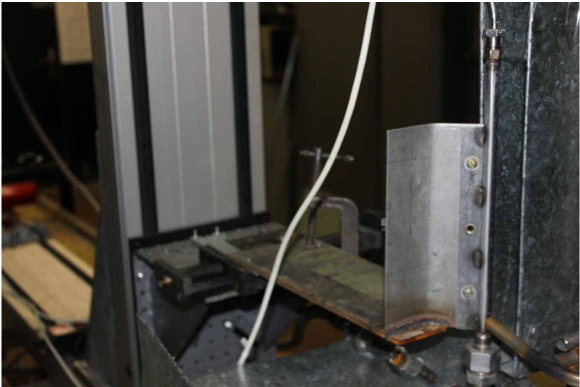
Рисунок 2.6.1 Трёхкоординатное сканирующее устройство с установленным объектом исследования (карбюратор)
