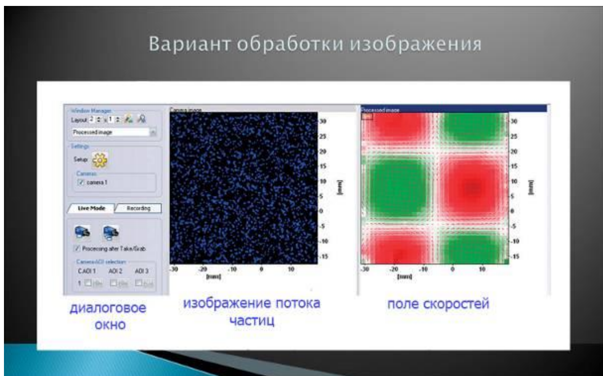
Рисунок 2.3.6 Пример нахождения поля скоростей по двухэкспозиционному изображению
