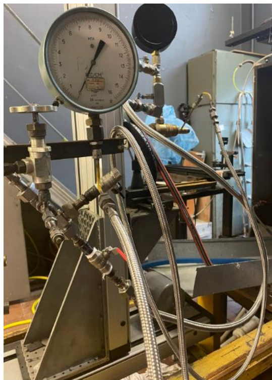
Рисунок 2.1.8 Манометр ГОСТ 2405-80 (до 16 кгс/см 2 )
