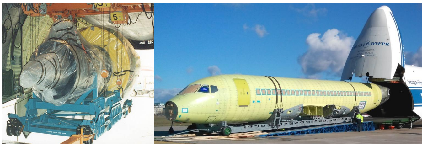
Рис. 8. Бортовой кран самолета Ан-124 (слева) и эстакада для погрузки длинномерного груза (справа)
