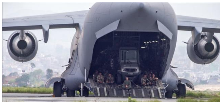
Рис. 5. Люк в хвостовой части ВТС С-17. Видны ребра, уменьшающие вихревое сопротивление фюзеляжа и нагрузки на хвостовую часть.
