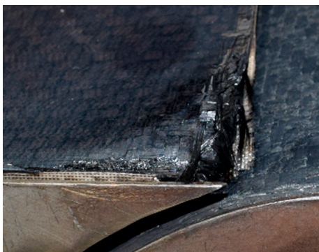
Рис. 4. Дефекты, обнаруженные на ПКМ-панелях после проведения стендовых испытаний
