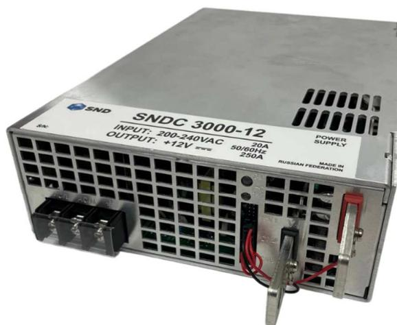
Рисунок 3 – Понижающий преобразователь SNDC 3000-12
