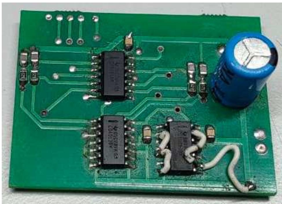
Рисунок 5.2 – Плата схемы управления ППН
