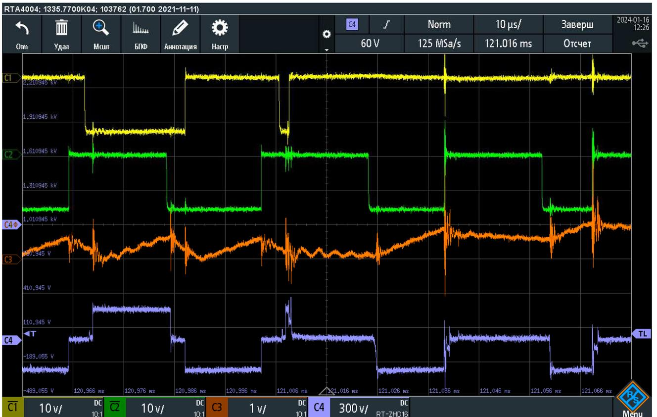
Рисунок 2.9 – Осциллограмма переходного режима ППН с микросхемой UCC3895: сверху вниз – сигнал управления 4 ключом; сигнал управления 2 ключом; ток в первичной обмотке трансформатора; напряжение на первичной обмотке трансформатора
