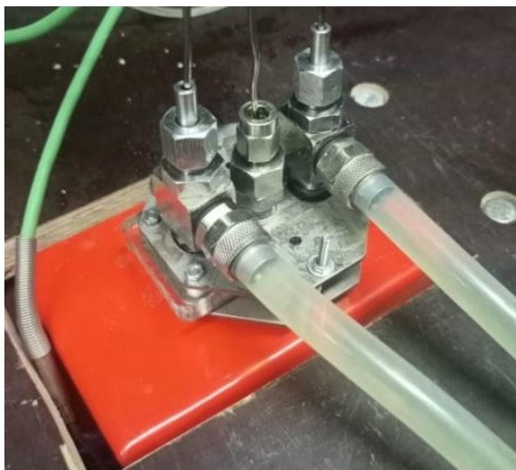
Рисунок 7 – Проведение гидродинамических испытаний образца
