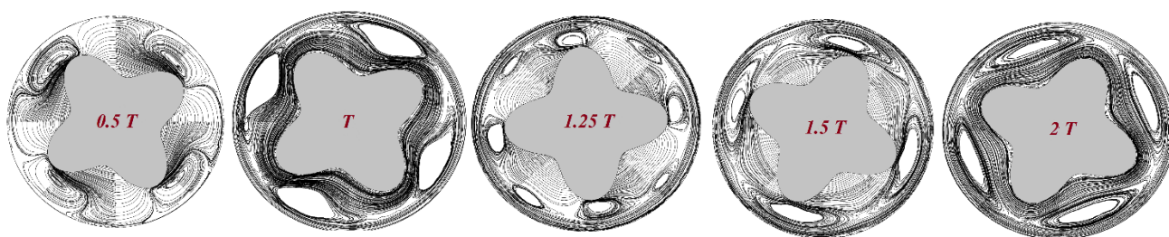
Рис. 3.12. Структура течения жидкости в моменты времени 0.5T , T , 1.25T , 1.5T , 2T .
