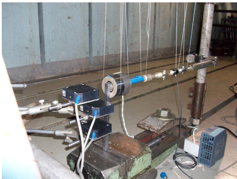
Рис. 5.16. Общий вид э установки. 1 – стержень; 2 – электромагнит; 3 – датчик силы; 4 – датчик перемещений; 5 – термогигрометр
