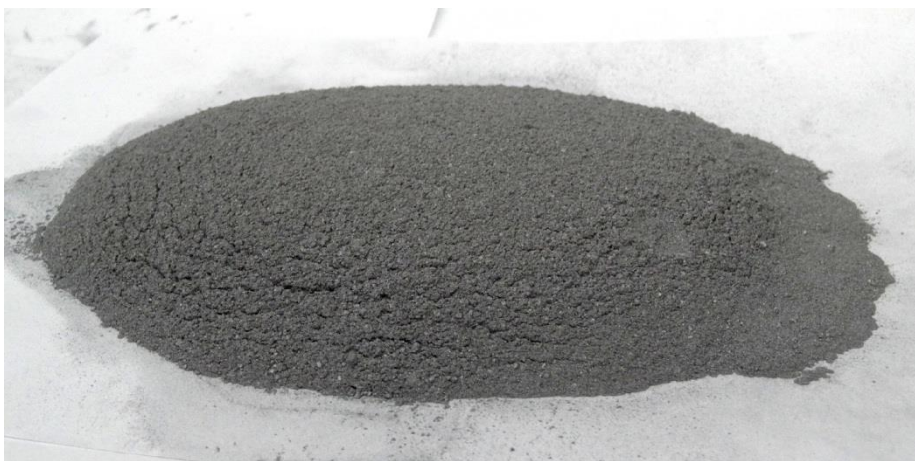
Рис. 3.5. Вид шихты, полученной гранулированием ПАП-2 с использованием воды.
