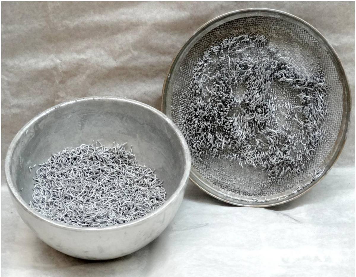
Рис. 3.12. Процесс образования гранул путем протирки влажной массы через сито
